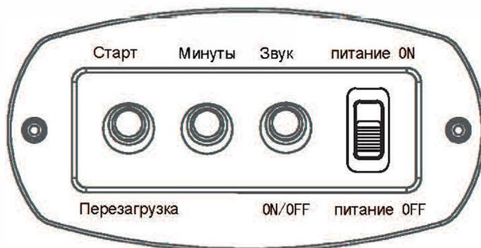
**Питание ON/OFF** - подвиньте бегунок ПИТАНИЕ ON/OFF чтобы вкл/выкл табло.
